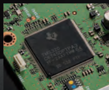
DSP Unit (Control Head)
